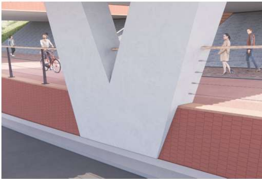
Kolom gezien vanaf rijbaan: kolomvoet steekt 5 cm uit ten opzichte van de wand, spankabels en handregel verzorgd bevestigd.
